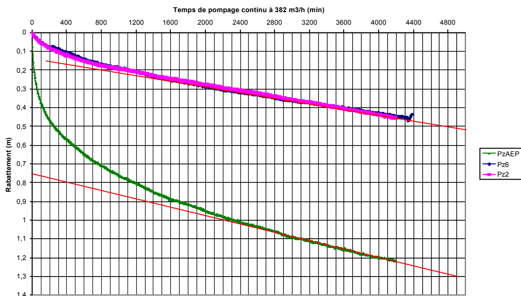
Figure 23 : Evolution des niveaux piézométriques sur les piézomètres PZ AEP, Pz 2 et Pz 6 au cours de l'essai de pompage d'octobre 2011 sur les captages de Saffré
